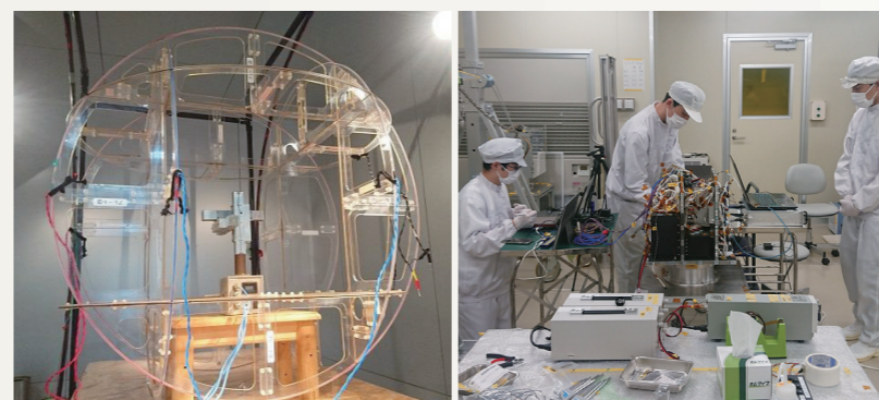
微小磁界を測定する磁気シールド室
