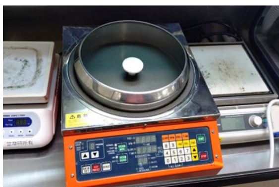
図 2. スピンコート製膜法 : スピンコート装置写真 (左) とその模式図 (右)
