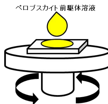
図 2. スピンコート製膜法 : スピンコート装置写真 (左) とその模式図 (右)
