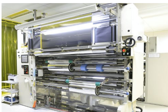
図 1. ロールツーロール法 (R2R 法) : 株式会社麗光 R2R 装置の写真 (左) とその模式図 (右)
