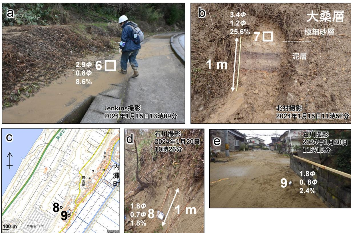
図 2 a: 試料 6 の採取地点。写真中の数値の意味は図 1 と同じ。b: 大桑層の露頭と試料 7 の採取地点。c: 石川県内灘町と試料 8 と 9 の採取地点。d: 内灘砂丘の陸側斜面の露頭と試料 8 の採取地点。e: 噴砂堆積物と試料 9 の採取地点。a の調査している研究者は北村晃寿教授。
