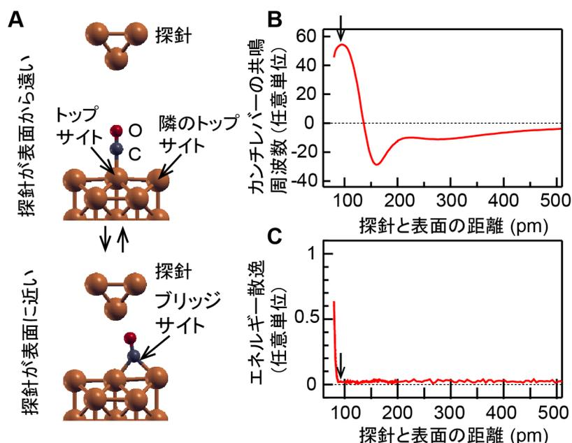
図 1. **A.** 探針を表面に近づけたり遠ざけたりするときの一酸化炭素 (CO) 分子の吸着状態の変化。探針が表面より遠いときは占有されていなかったブリッジサイトが、探針が近づくことで占有されます。**B.** 探針を表面に近づけると、矢印の位置で吸着状態が変化し、それに伴い原子間力顕微鏡のカンチレバーの共鳴周波数も大きく変化します。**C.** 振動する探針を矢印の位置まで近づけると、探針の振動に同期し分子の吸着状態がトップサイトとブリッジサイトの間でスイッチングし、そのたびにエネルギーの散逸が起きます。
