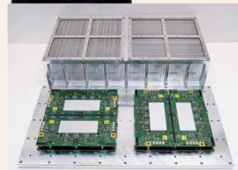
±45度ぐらいの視野の広さを持ち、すり抜けたX線の影でガンマ線バーストの発生方向を特定できる検出器を米徳教授が開発。金沢大学衛星1号機「こよう」に搭載。
