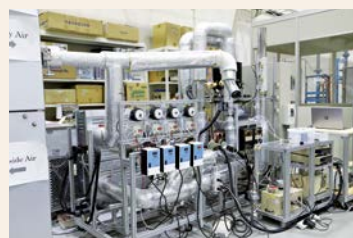
空気からの二酸化炭素回収・濃縮実験装置。さまざまな空気環境を再現できる空調設備に接続し、空気の温度や湿度の影響も検討できるようにしています。
