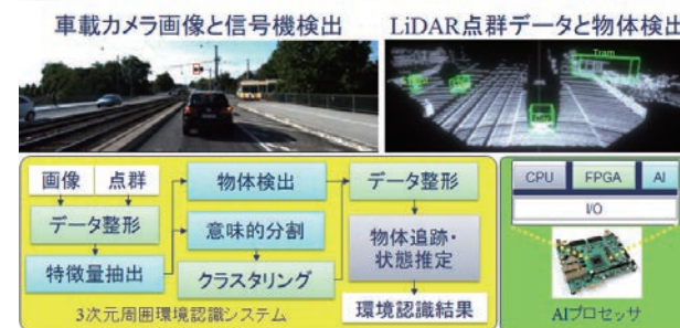
自動運転向け周囲環境認識 AI プロセッサ
