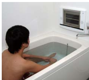
浴槽内の電極が生体の微弱な電気現象を感知。心電図や呼吸の波形を正面モニターに映し出す
