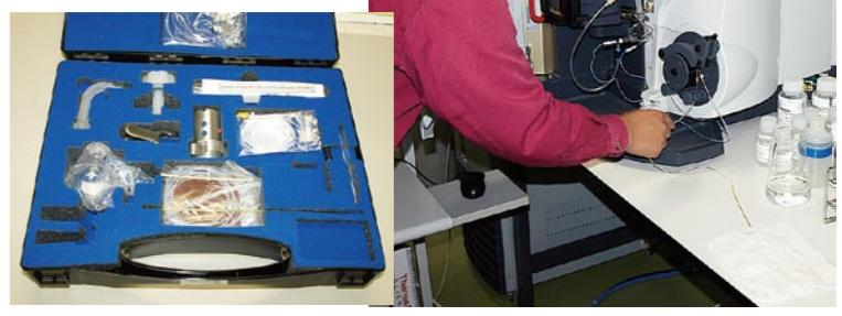
海水中的微量元素の濃度を測定するためのキット(左)と分析装置(右)
