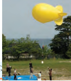
気球を飛ばして大気観測や黄砂採取を行う(大気観測・能登スーパーサイト)
