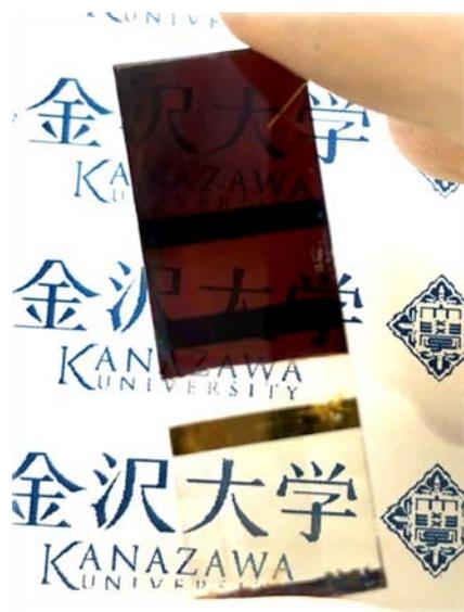
図 1. 本研究で作製したペロブスカイト太陽電池の写真
