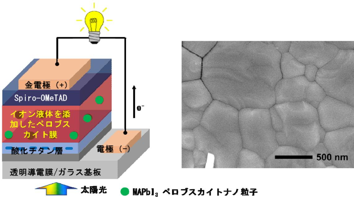
図3. 本研究の太陽電池の構造とイオン液体を添加して高品質化したトリプルカチオン型ペロブスカイト膜の表面電子顕微鏡写真
