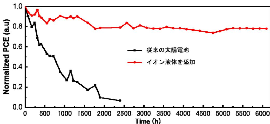
図 5. 湿度 30%~40%範囲の通常大気下での暴露試験の結果
