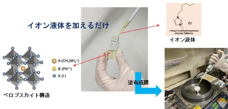
図 2. イオン液体を一滴加えるだけでペロブスカイトナノ粒子薄膜が得られる技術を開発
