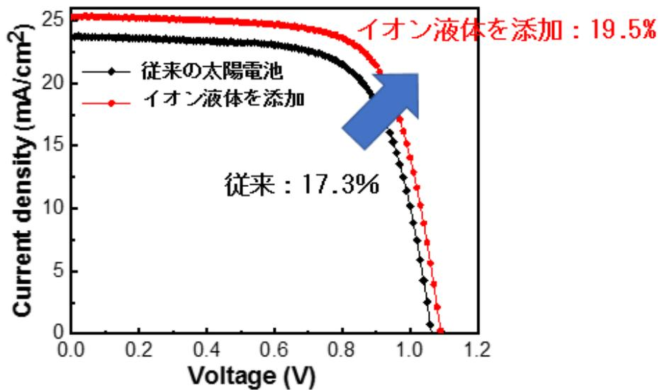
図4. 疑似太陽光照射時の電流-電圧特性
