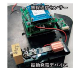
無線通信センサーと振動発電デバイス
