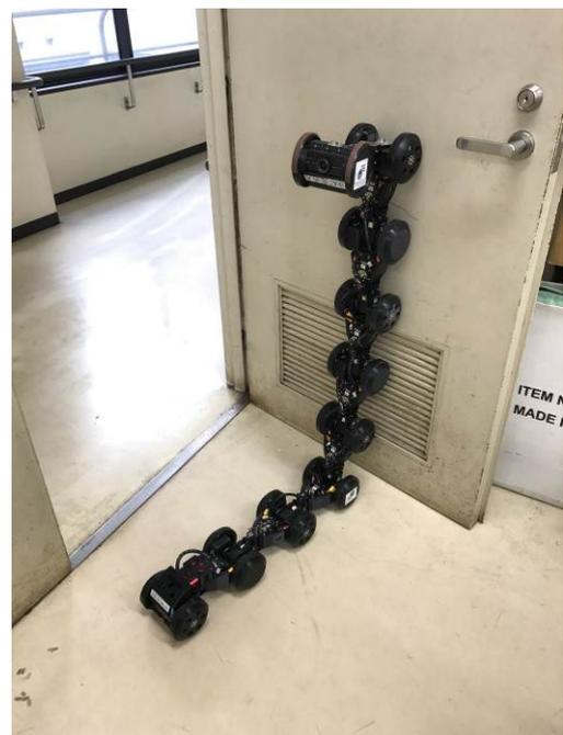
図7 壁を使って先頭を高く持ち上げる
