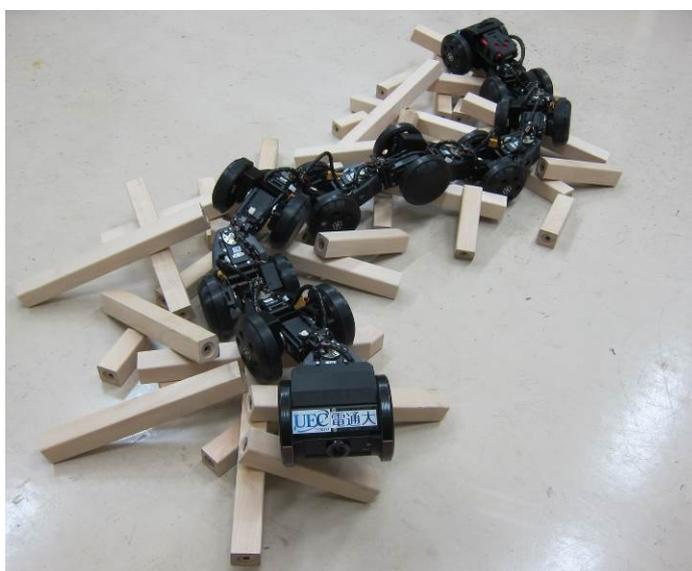
図1 ヘビ型ロボット「T<sup>2</sup> Snake-3」
