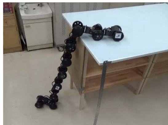
図4 高さ1mの段差登り
