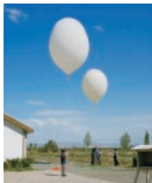
自由気球による粒子の直接採集(敦煌市・中国)
