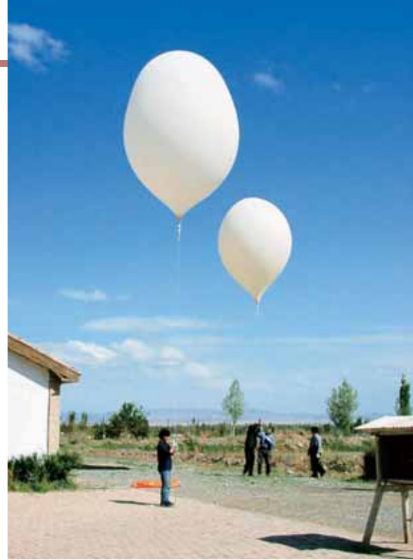
自由気球による粒子の直接採集（中国・敦煌市）
