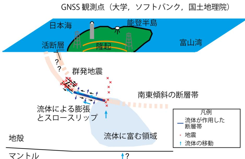
●能登半島の群発地震のメカニズムの模式図。GNSSデータの解析から、地殻深部の流体が断層帯内を拡散することにより断層帯の膨張とスロースリップを引き起こし、さらにその浅部で活発な地震活動を長期にわたって引き起こしていることが示唆されます。
